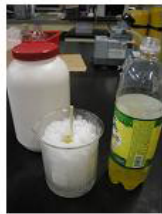
6. 기다리는 동안 소금을 넣은 비이커의 표면과 소금을 넣지 않은 비이커의 표면의 변화를 느끼게 한다. (소금을 넣은 비이커의 경우 비이커의 표면에 얼음이 낀다.)
