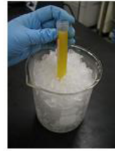
4. 3번을 양쪽의 비이커 얼음 사이에 꽂는다. (소금이 들어있는 얼음비이커와 소금이 들어 있지 않은 얼음비이커의 음로수의 동등 변화를 비교하도록 한다.)
