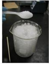
2. 한쪽의 비이커에는 얼음과 소금의 비율이 3:1이 되도록 소금을 골고루 뿌리고 막대로 잘 저어준다. 한쪽의 비이커에는 소금을 넣지 않고 비교하도록 한다.
